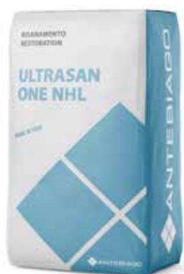
**ULTRASAN ONE NHL** è un intonaco monoprodotta da risanamento (R), macroporoso, deumidificante, ad elevata traspirabilità, a base calce idraulica NHL 5. Utilizzabile come strato di rinzafo, promotore di adesione e come intonaco di fondo.
