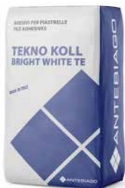
**TEKNO KOLL BRIGHT WHITE TE** è un adesivo cementizio (C1) a scivolamento verticale nullo (T) e tempo aperto prolungato (E). Prodotto formulato a base di leganti idraulici, inerti selezionati e specifici additivi che ne migliorano la lavorabilità. A bassissime emissioni di VOC.
