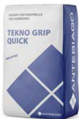
**TEKNO GRIP QUICK** è un adesivo cementizio autobagnante ad elevate prestazioni meccaniche (C2), a presa rapida (F) ed ottima lavorabilità. Specifico per applicazioni a presa rapida e con pedonabilità in tempi brevi (4 ore circa). Prodotto formulato a base di leganti idraulici, inerti selezionati e specifici additivi che ne migliorano la lavorabilità. A bassissime emissioni di VOC.
