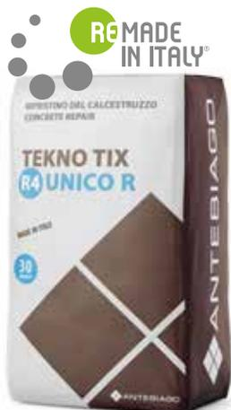
**TEKNO TIX R4 UNICO R** è una malta tixotropica, fibrorinforzata, espansiva all'aria, multifunzionale, a presa rapida 30 min e ad azione passivante. Conforme alle norme EN 1504-3 (Classe R4), EN 1504-2 e EN 1504-7. Prodotto formulato a base di leganti idraulici, inerti selezionati, aggiunte minerali ad attività pozzolanica, fibre polimeriche ed additivi specifici.
