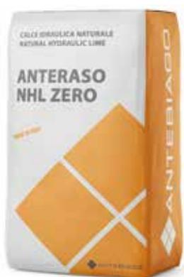
**ANTERASO NHL ZERO** è un rasante extrafine ad alta traspirabilità specifico per la realizzazione di rasature ad effetto liscio. Prodotto formulato a base di calce idraulica naturale NHL 5, inerti selezionati e specifici additivi.
