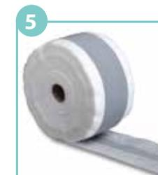
**5** Bandella in tessuto di PP impermeabile all'acqua ed al vapore con rete in poliestere, per l'impermeabilizzazione dell'angolo interno tra parete e pavimentazione, utilizzabile anche per sigillare il passaggio delle tubazioni tra stanze attigue.
