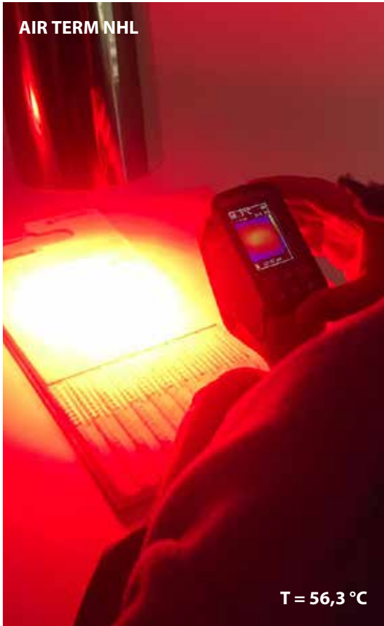
Figura 14 Un campione di AIR TERM NHL (sinistra) ed uno di rasante tradizionale bianco (destra) esposti ad una intensa radiazione infrarossa. Dopo 10 minuti, la temperatura superficiale di AIR TERM NHL è risultata di 56,3 °C, mentre quella del rasante bianco tradizionale è risultata di 70,8 °C, con una differenza di ben 14,5 °C.
